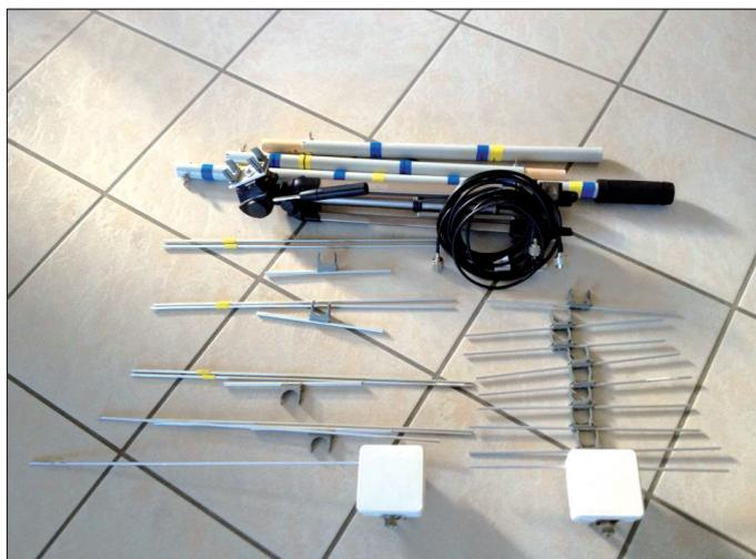
Sat-Antenne, reisefertig zerlegt
