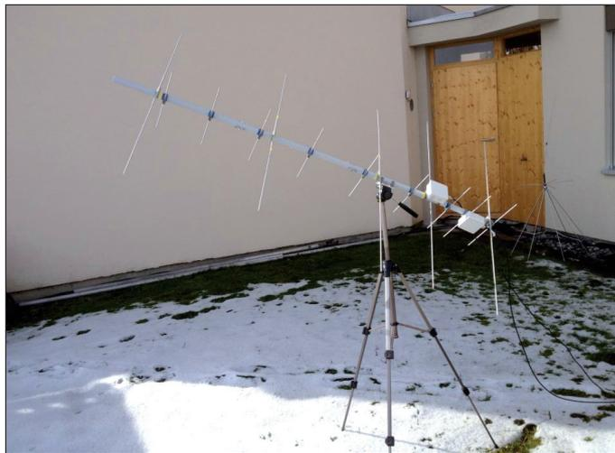
Testaufbau der SAT-Antenne im Heim-QTH
